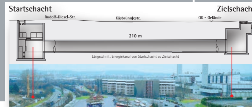
Der 210 Meter lange Energietunnel für die Wärmeauskopplung aus dem Kraftwerk der Daimler AG wird gebaut
