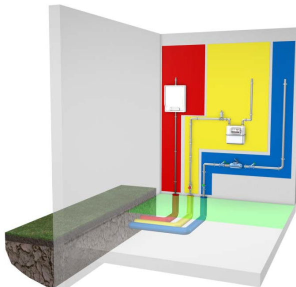
Einsparten-Hauseinführungen über Bodenplatte
